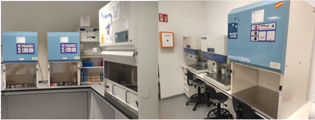
Fig 5. Cabinas de Flujo Laminar de 120cm y 90cm
