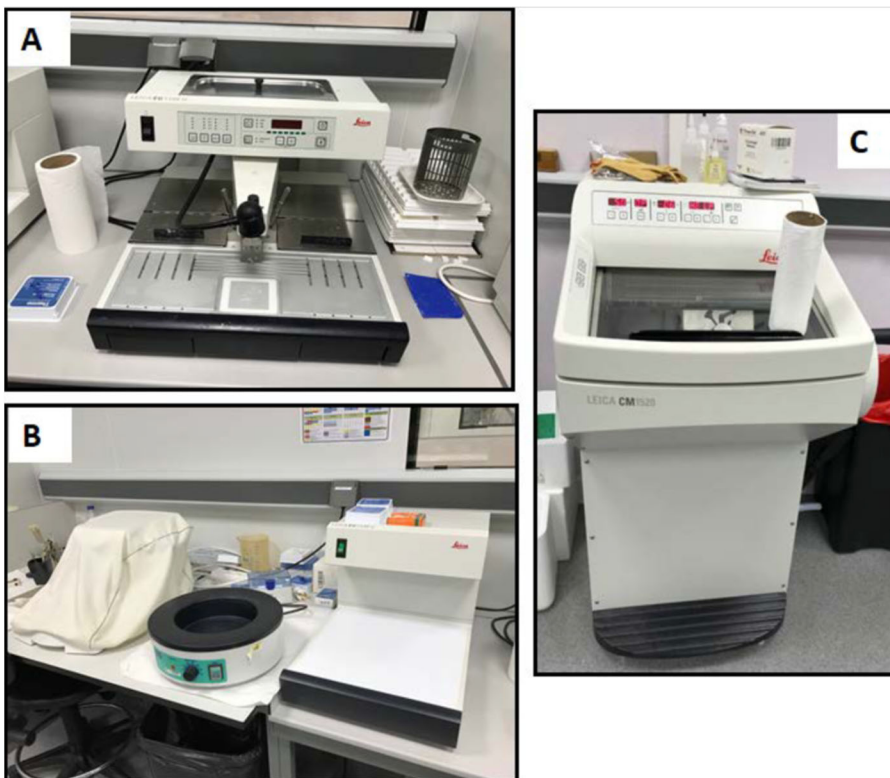
Fig 9. Incluidor de Tejidos (A), Baño termostatizado, micrótopo y placa fría (B) y criostato (C)
